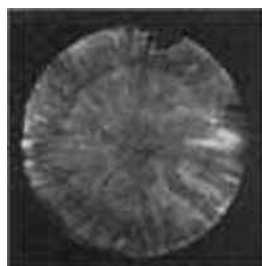
Abb. 5c. Kokillenwirkung bei einem Rundstab.
