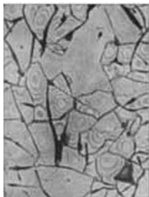
Abb. 5a. Thermisilid, 16% Si, langsam abgekühlt.
